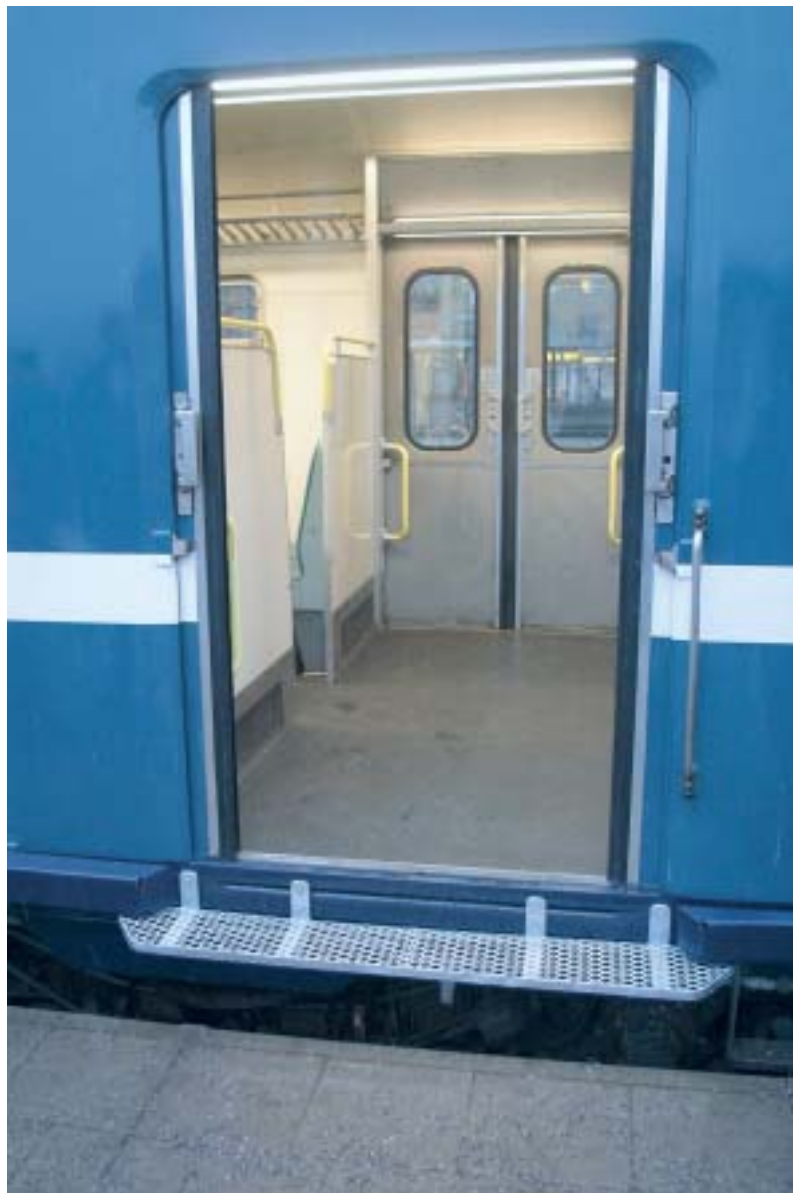
X420 har fått ett extra fotsteg vid varje dörr. Foto Jan Lindahl.
